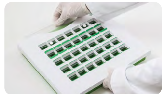
4. Tabletten fallen in die Blistereinsätze. Schließen und den Vorgang wiederholen.
